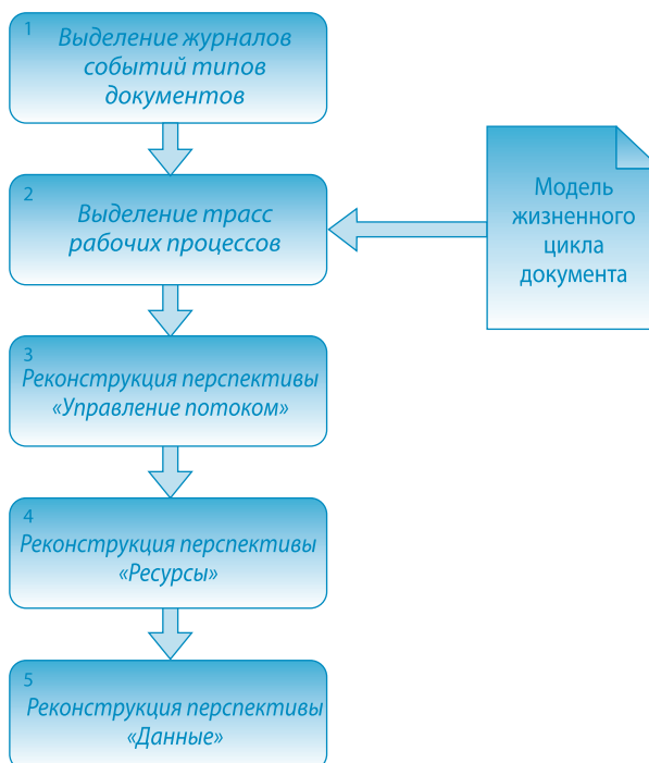
Рис. 3. Схема процесса реконструкции рабочих процессов документооборота
